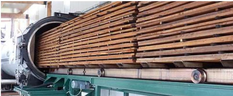
Le bois est introduit dans le four qui monte en température dans une atmosphère contrôlée. Quand la température approche les 100°C une quantité d'eau est injectée dans l'enceinte, cette eau se vaporise et la pression dans le four va augmenter. Ensuite, le four procède à une période de refroidissement.
