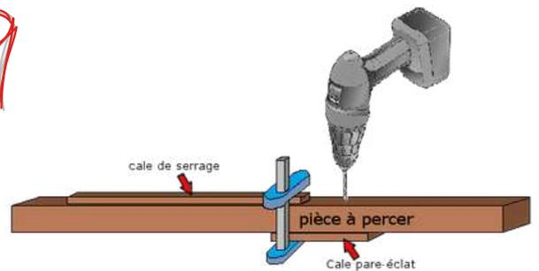
Percer avec un pare-éclat et boulonner les pentures.
