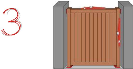
Mettre d'aplomb le vantail, puis le régler (régler les jeux du pilier à l'aide de cales de 25mm).
