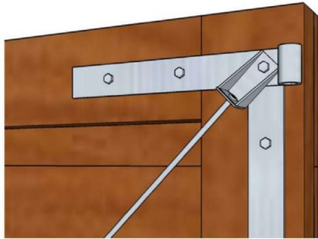
Fixer l'extrémité du tirant (partie sans le tendeur) sur le boulon le plus haut de la penture haute. Veillez à bien vous fixer sur le montant du vantail. **NE PAS BLOQUER L'ÉCROU.**
