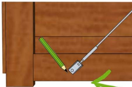
Câble tendu, tracer l'emplacement de l'autre extrémité du tirant (partie avec le tendeur). Veillez à vous placer au delà des 2/3 de la longueur de la traverse basse du vantail et au milieu de la largeur de cette traverse.
