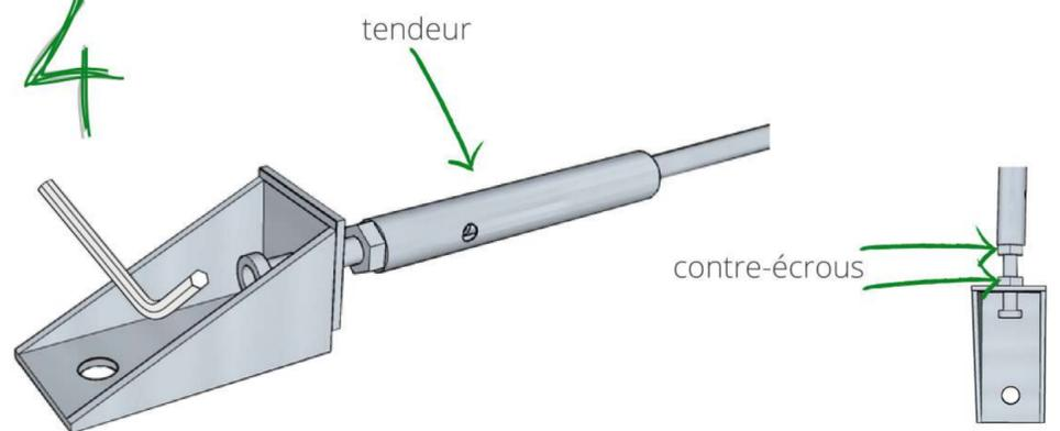
Procéder au serrage du tendeur. Visser la vis à l'aide d'une clé Allen
