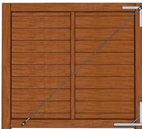
Schéma de pose d'un tirant inox
